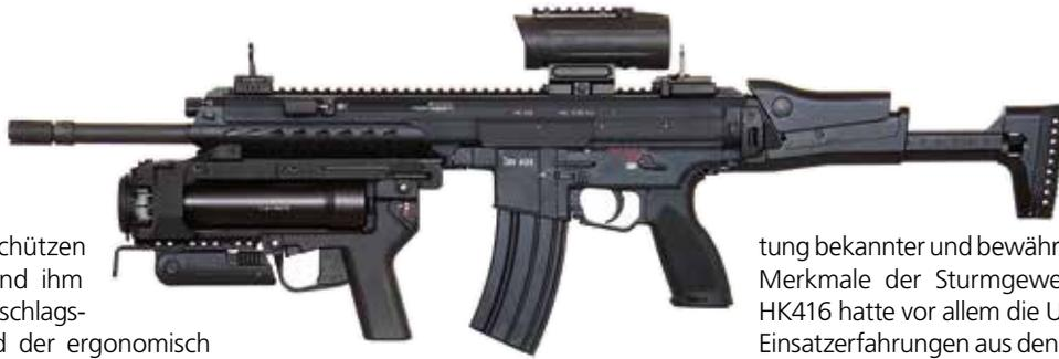
Sicherheit für den Schützen in Stresssituationen und ihm stehen nahezu alle Anschlagarten offen. Aufgrund der ergonomischen optimalen Positionierung des Durchladehebels kann das HK433 beim Durchladevorgang im Ziel gehalten sowie im Liegen ohne Erhöhung der Körpersignatur bedient werden.
